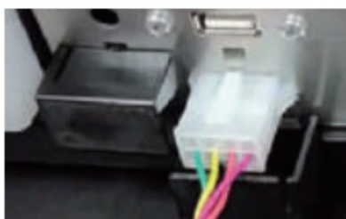
7. Připojte kabel ke kávovaru
